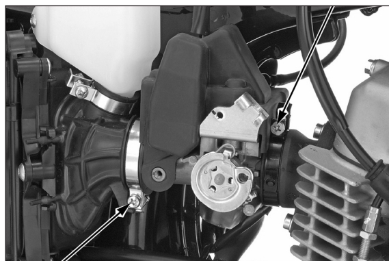
PARAFUSO DA BRAÇADEIRA DA MANGUEIRA DE CONEXÃO
